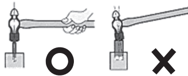
図 4.4 ハンマの打ち方
