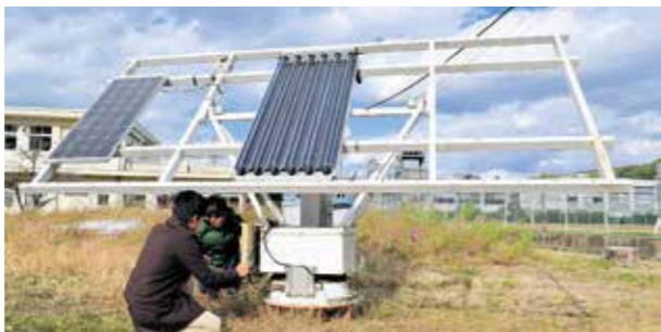
(写真) 徳島大学生物資源産学演習林内(石井町)に設置した二軸太陽追尾システム
