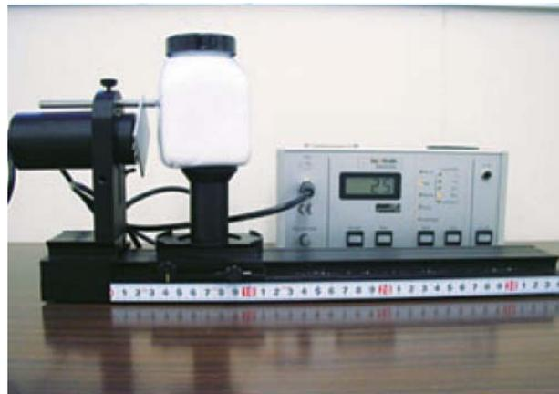
GM 計数装置による放射線計測
