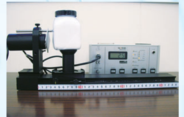
図2 GM計数装置による放射線計測
