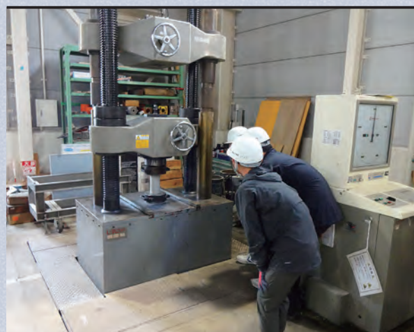
コンクリートの強度試験
