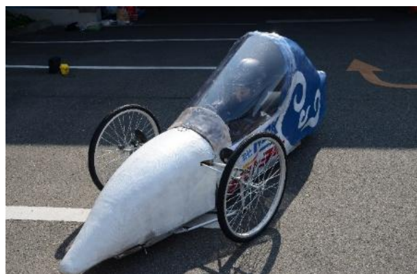
図 2 FRP 製カウルを搭載した競技車体
