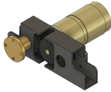
図1 ギアボックスのCAD
