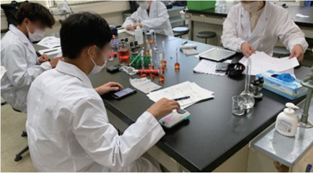
図 2 スマートフォンを使用して吸光度を測定している様子
