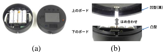
図3 ロボットの分割 (a) 春夏・秋冬講座用にロボットを分割, (b) はめあい構造
