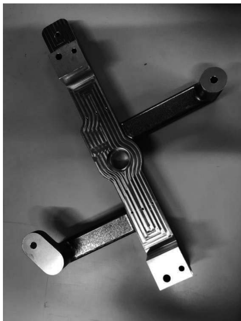
図4 製作依頼した軸受け部分
