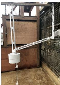
Fig. 1 しろとり動物園に設置した給餌装置
