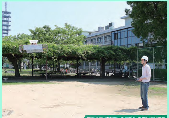
空中台車(運搬マルチコプタ)の自動操縦実験
