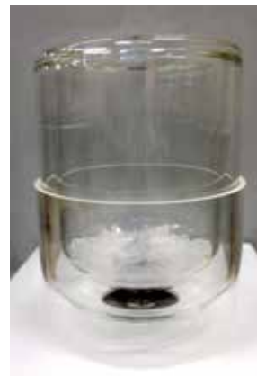
図2 反磁性による磁気浮上
