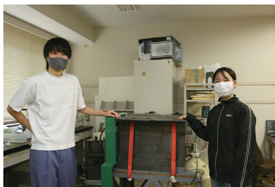
中央の黒いブロックを積み上げたようなものは、ダークマター探索装置の縮小モデル。2週間に1回液体窒素を入れて低温に保つのが大変だったそうです。
