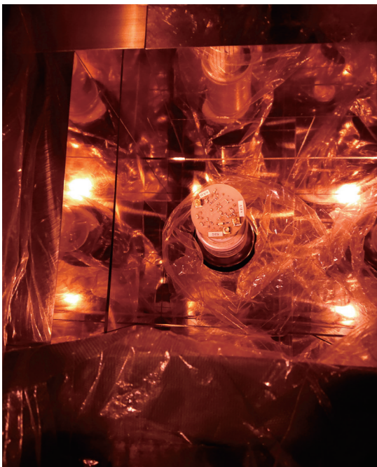
岐阜県飛騨市の神岡地下実験室に設置した、ピコロンの装置。赤くなっているのは、通常の光を当てると装置の感度に悪影響を与えるためです。この装置で、現状世界1に並ぶレベルの低バックグラウンドを達成しました。
