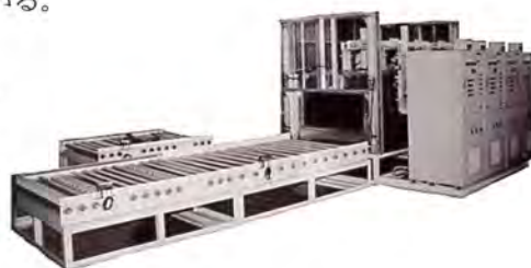
▲写真① マイクロ波加熱装置 (1t/バッチ1993年製造)
