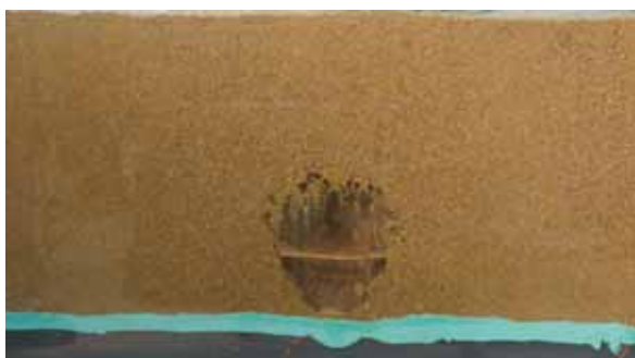
発生した空洞とフィーダーセンサ(正面)
