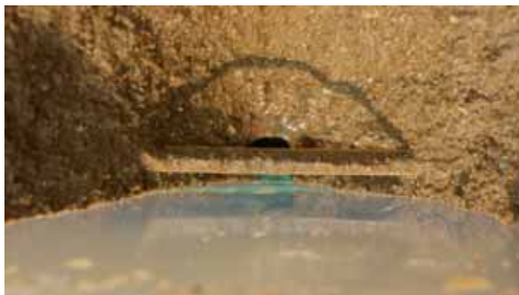
発生した空洞とフィーダセンサ (実験終了後、平面)
