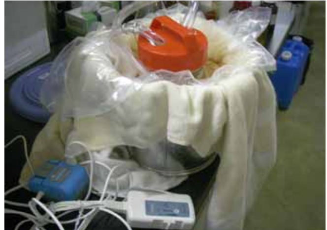
図1 遠赤外線有機溶剤活性化装置
