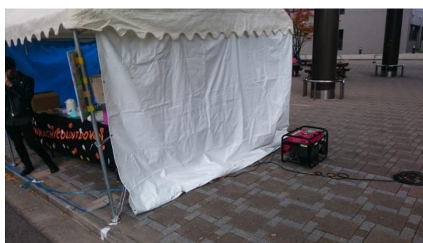
図7 ガソリンを燃料とする発電機
