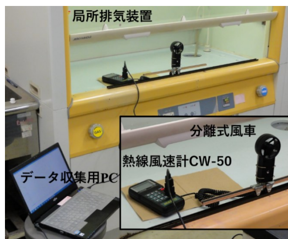
図1 風速の連続時分割測定の様子
