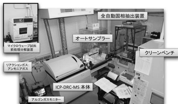
図7 本学医学部保健学棟に設置されているリアクションセル方式誘導結合プラズマ質量分析システム<sup>31)</sup>
