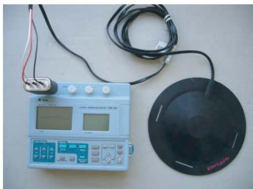
写真1 振動計および座席用振動ピックアップ
