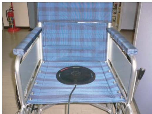
写真2 車椅子の座面に設置した座席用振動ピックアップ
