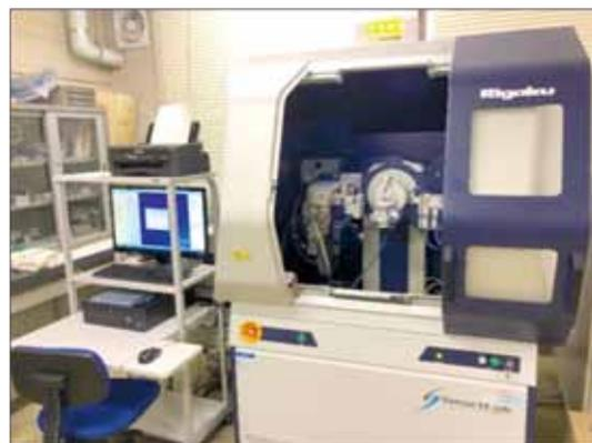
図1 粉末X線回折装置
