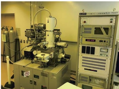
図 2. 電子線リソグラフィー装置
