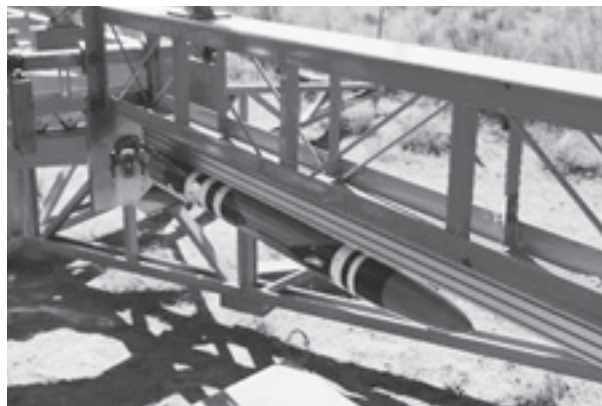
写真1. I型ハイブリッドロケット
