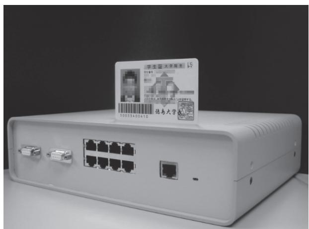
図 5 中継装置外観
